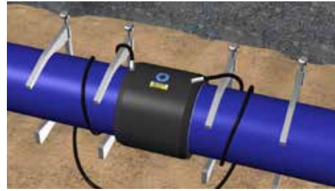
Abbildung C.16: Anschließen der Schweißkontakte
