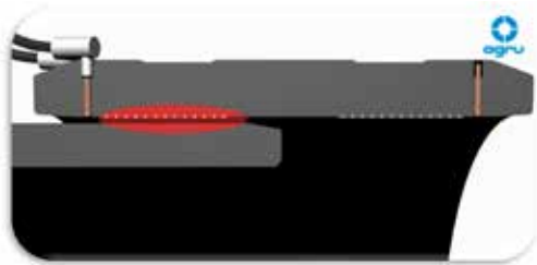
Abbildung C.17: Prinzip des bifilaren Heizwendelschweißens
