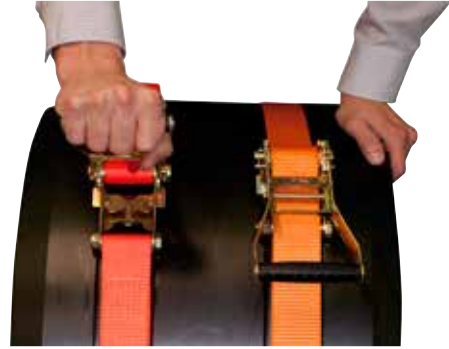
Abbildung C.23: Spannen des Gurtes.
