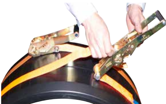
Abbildung C.22: Einfädeln des Spanngurtes
