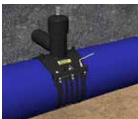
Abbildung C.37: Montage des Druckanbohrventils
