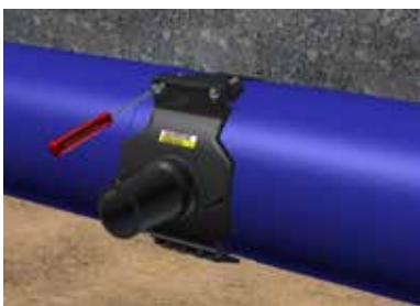
Abbildung C.30: Montage der Stutzenschelle
