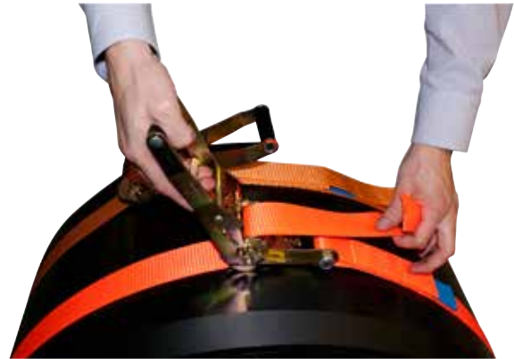
Abbildung C.24: Öffnen des Spanngurtes
