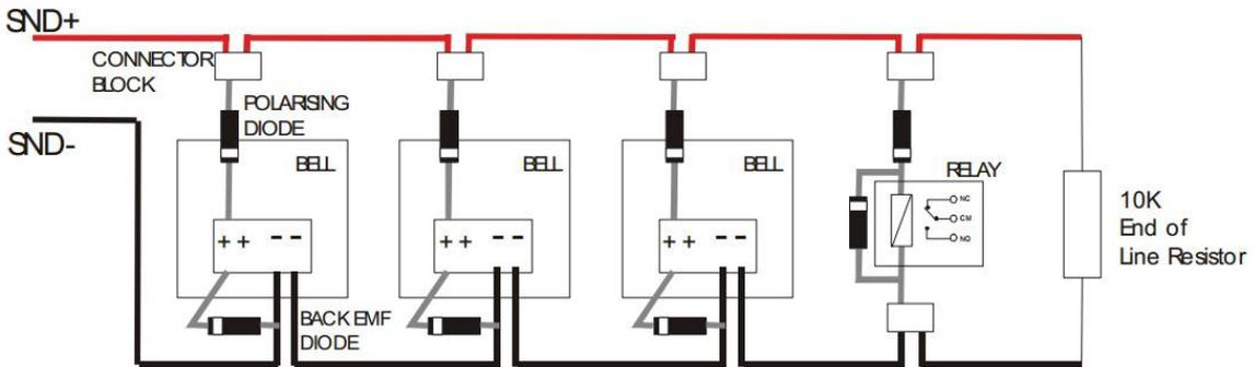
**2.5 AUXILIARY OUTPUT WIRING (VOLTAGE FREE CHANGEOVER CONTACTS)**
